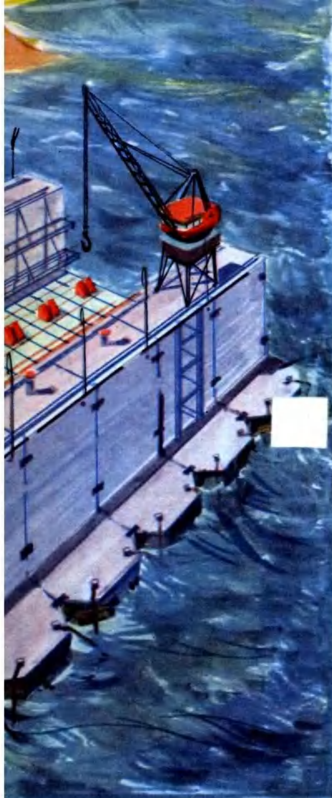
ЦИСТЕРНЫ ДОКА ЗАПОЛНЕНЫ ВОДОЙ БУКСИР ВТЯГИВАЕТ КОРАБЛЬ
